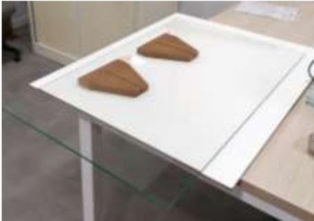
2. Mettez votre écran vertical et rentrez les pieds en force. Les positionner verticalement, à égale distance du bord (idéalement 20 à 30 cm) et les enfoncer jusqu'au fond de la gorge
